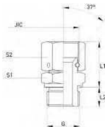
Gerader Einschraubstutzen Typ 15-28/J.. GD.. / Adjustable straight connection type 15-28/J..GD.. zölliges Einschraubgewinde parallel, Anschlussseite JIC 37° Überwurfmutter / BSP thread parallel, one side JIC 37° with nut
